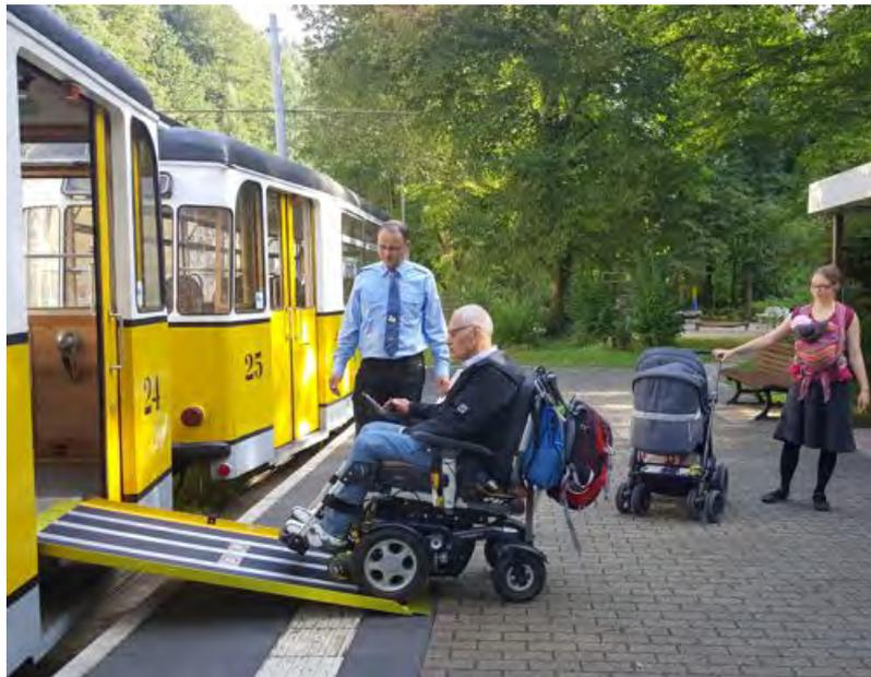
Mit dem begonnenen Umbau der letzten Haltestellen könnte nach dem Beispiel der Kirnitzschtalbahn bei den meisten eingesetzten Fahrzeugen eine vollständige Barrierefreiheit erreicht werden. Durch den Einsatz markterprobter Faltrampen ist dann auch die Beförderung von Rollstühlen möglich.
